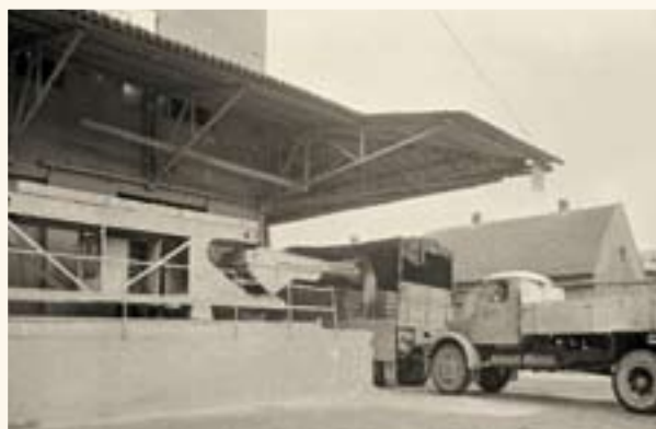
Teleskopické pásy v expedici pytlovaného cementu
