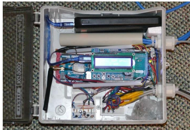
Obr. 2. Zařízení určené pro lom Mokrá s Li-Pol power bankou 30 000 mAh, které je schopno nepřetržitě měřit a v 15min. intervalech po dobu 3 týdnů zpřístupňovat data on-line.
