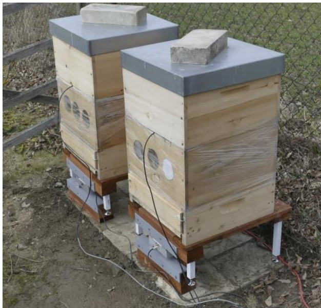
Obr. 4. Včelí úly v časně jarním období umístěné na speciálním podstavci s integrovaným váhovým senzorem.
