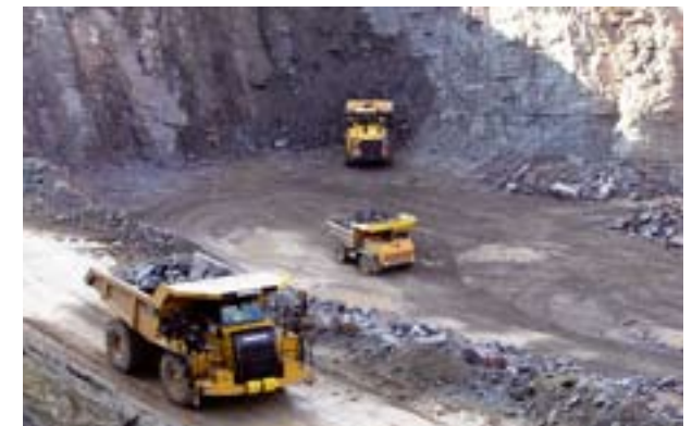
Nakládka a odvoz rubaniny do drtiče
