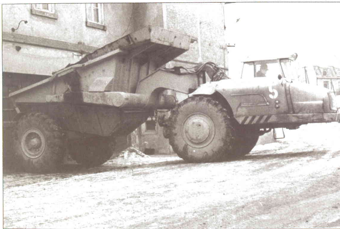
1960 - jednoosý traktor T 180A s dumperem D10
